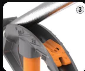
3 Inserte el tubo conduit en el cabezal del doblador y prepárese para doblarlo como de costumbre.
