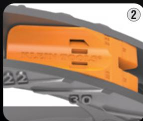
2 Con la palma de la mano, presione el Angle Setter™ firmemente en su lugar, hasta que quede al ras con los costados del canal del doblador; asegúrese de que las pestañas de alineación estén correctamente colocadas en las muescas de alineación.
