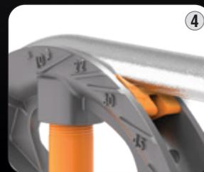
4 Doble el tubo conduit hasta que sienta que entra en contacto con el Angle Setter™. Funciona para dobleces en el suelo y aéreos.
